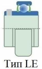
Подшипник шариковый **LE 212 2ТВ** (FKL) со сферическим наружным кольцом и дополнительной защитой от агрессивной среды.
